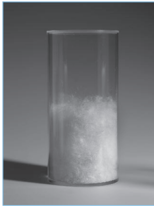
Les flocons de duvet usagés perdent leur capacité de remplissage. L'isolation thermique et la régulation de l'humidité sont réduites.
