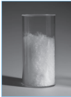
Par la régénération, les flocons de duvet retrouvent leur pleine capacité de remplissage. Les brins et les fibres des flocons brisés sont éliminés.
