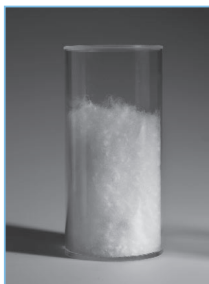
Durch die Reinigung erhalten die Daunen wieder die ursprüngliche Füllkraft. Abgebrochene Teilchen und Einzelfasern werden aussortiert.
